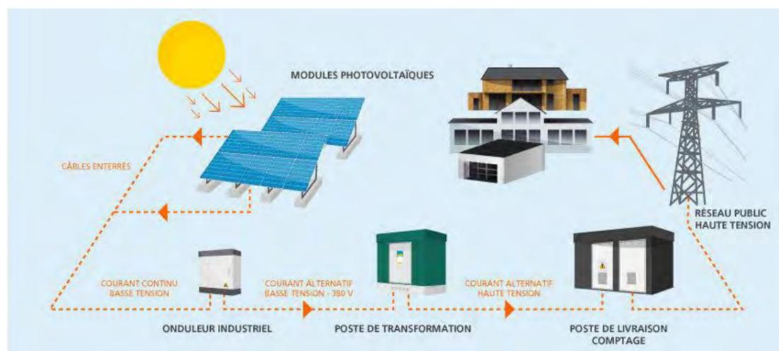
Figure 5 - Fonctionnement générale d'une centrale photovoltaïque Source spécifiée non valide.
