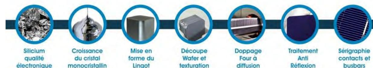
Figure 6 - Procédés de fabrication d'une cellule cristalline semi-conductrice de silicium (Jade Technologie, s.d.)
