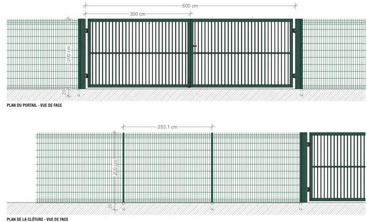
**Figure 17 : Plan des clôtures et du portail**
