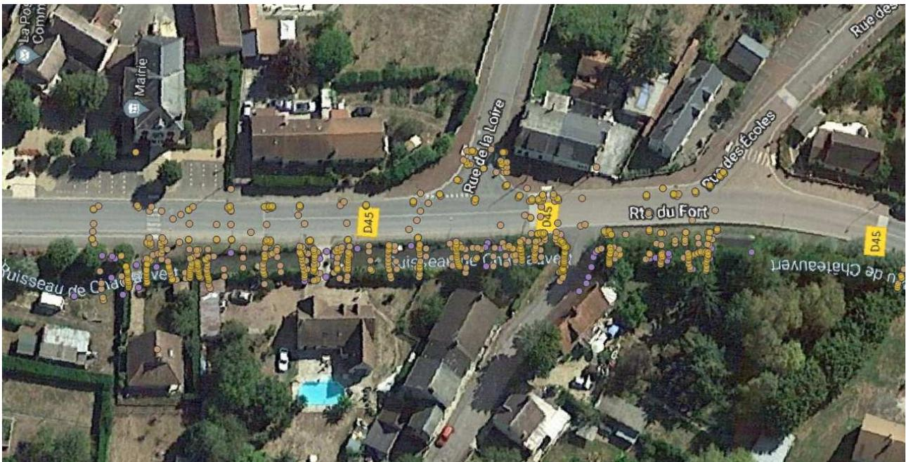
Figure 21. Aperçu des données topographiques acquises sur le terrain. Points orange : points utilisés pour la construction du MNT. Points violets : points rejetés lors de la construction du MNT
